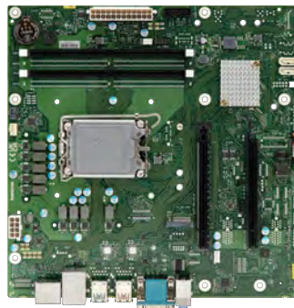
Micro-ATX: 243.8 x 243.8 mm (K3843-B2 µATX)
