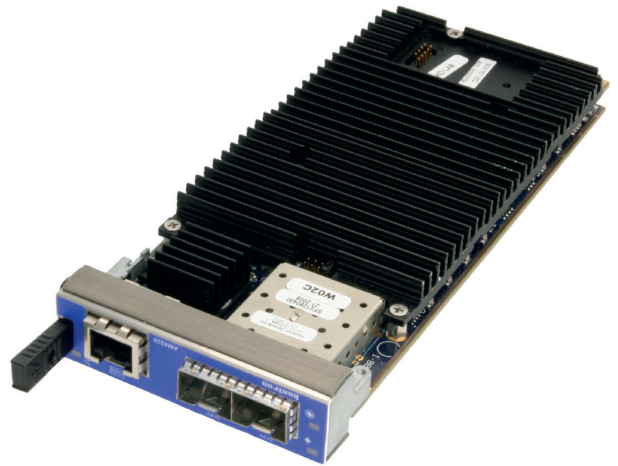
Рис. 6. Специализированный вычислительный модуль Kontron AM4220 выполнен на основе 12-ядерного процессора Oxeon Plus CN5650 с тактовой частотой 800 МГц
