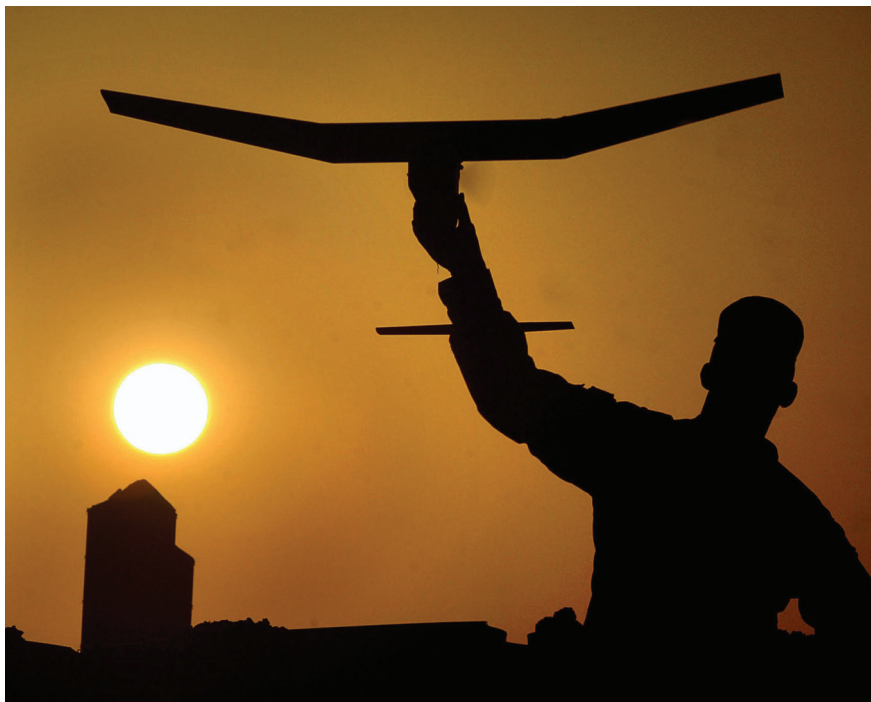
Рис. 3. Семейство малых БПЛА (Small UAS – SUAS) включает аппараты, запускаемые рукой или катапультной и управляемые человеком либо специальным ПО, которое использует данные автономной системы GPS-навигации. Такие аппараты обычно летают на малых высотах и пригодны для осуществления ночных и дневных разведывательных миссий
