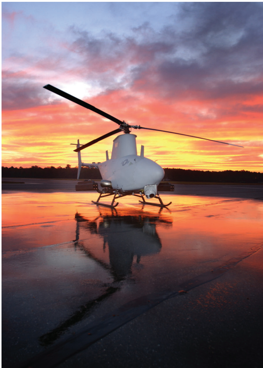
Рис. 4. Тактические БПЛА вертикального взлета и посадки (Vertical Takeoff and Landing Tactical UAV – VTUAV) способны взлетать и садиться на неподготовленные площадки в непосредственной близости от войсковых и тактических оперативных центров. Действуя как коммуникационные узлы объединенной тактической системы радиосвязи JTRS (Joint Tactical Radio System), они повышают эффективность и гибкость этой сети.
