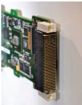
Рис. 1. Разъем MultiGig RT2 обладает всеми требуемыми характеристиками и уже используется в спецификации VITA VME64
