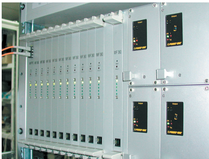
Крейт MIF-контроллера включает до 15 интеллектуальных модулей
