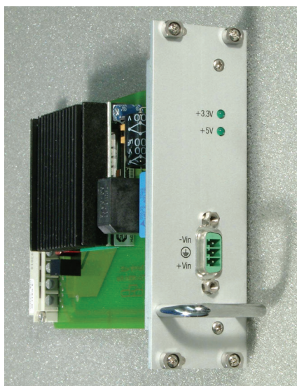
Рис. 3. ИП от сети постоянного тока CP3-SVE-M75DC, поставляемые Kontron вместе с оборудованием CompactPCI, обеспечивают питание от сети с входным напряжением от 20 до 60 В
